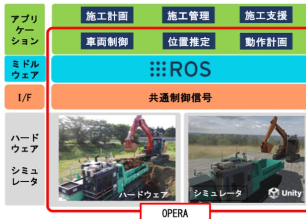
図1 土木研究所が想定する自律施工システム構成及び OPERA により提供される要素 (枠内)
