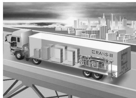
図2 屋外測定を行う RANS-III のイメージ
