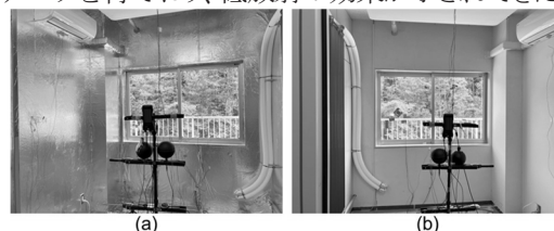
図3 (a)低放射室と(b)標準室での低放射（アルミ箔）内装材の温熱環境、暖冷房負荷、快適性の実験
