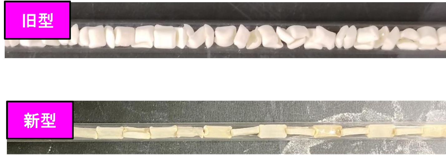
図6. ガラス管に充填したTiO 2 セラミック. 端面に凹みを加えることで、互い違いに充填可能. → 影をなくすことで 受光率の改善 に成功
