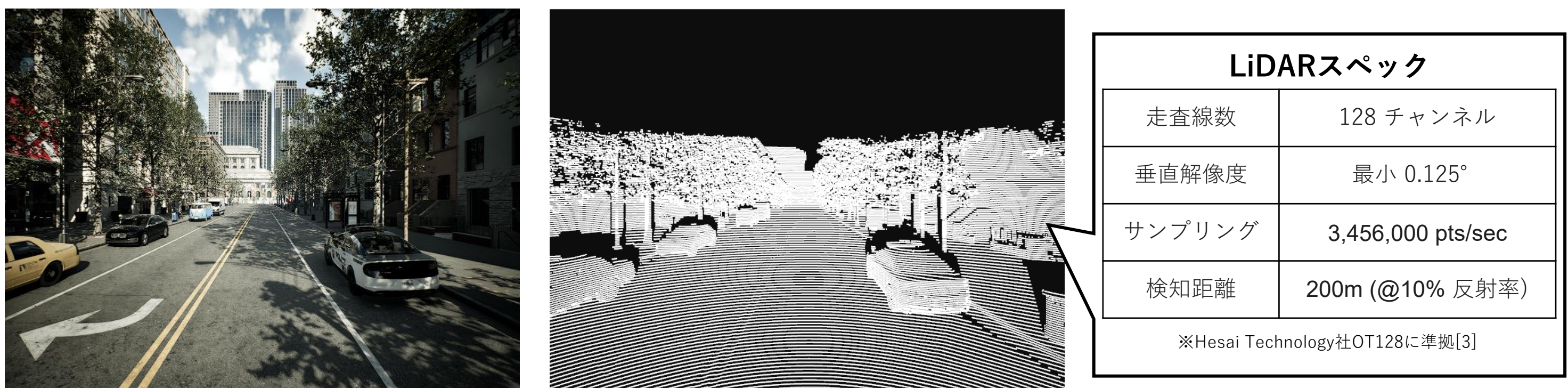
図4 カメラ映像 (左) と LiDAR 点群データ (右) の視認性比較
