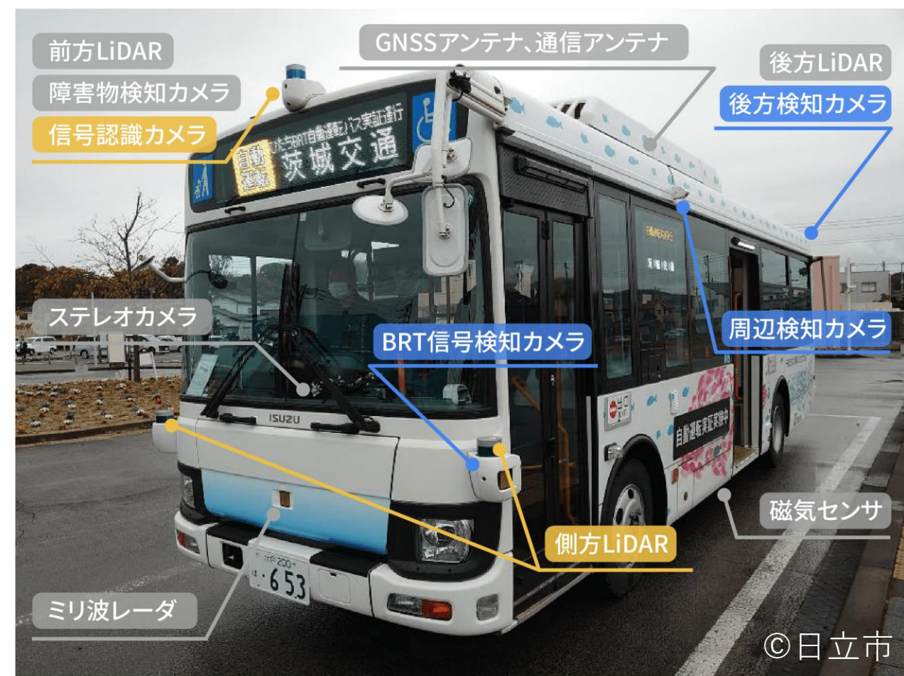
図2 自動運転車両に搭載される主要センサ[2]
