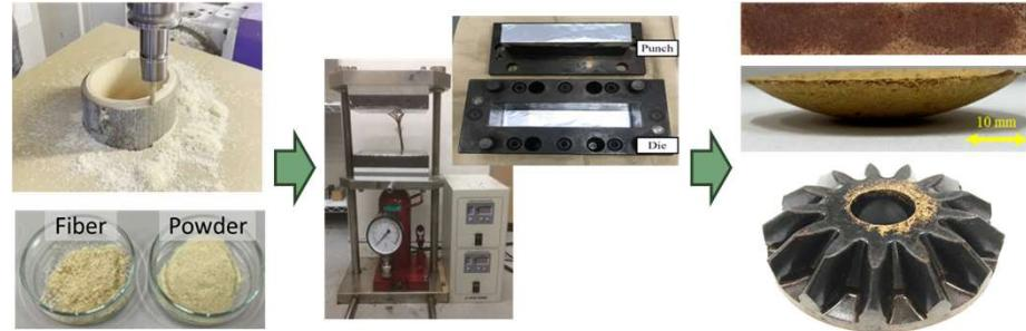
材料として竹筒を切削した際の切りくず（竹繊維・粉末）を使う
