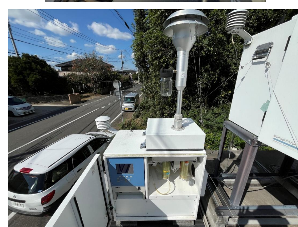
図4 PM2.5自動測定装置(上) PM2.5試料採取装置(下)
