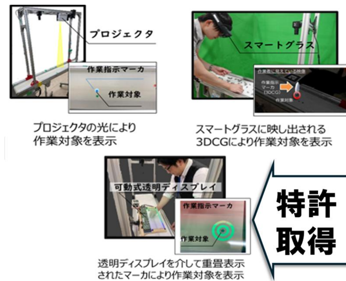
図1 MRデバイスを用いた3種類の異物除去作業支援システム
