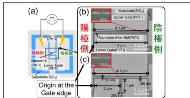
図1 ナノワイヤの模式図(a)とEM後のサンプルのFESEM像(b)ノッチ構造のない試料(構造0)(c)ノッチ構造のある試料(構造2)
