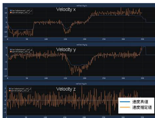
図2 各軸方向の真値速度(青)と最適化速度(橙)。上からx方向,y方向,z方向。
