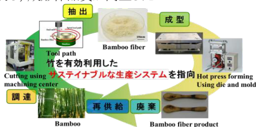
図1 竹と精密加工を融合した持続可能な生産システム
