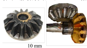
図4 竹繊維100%自己接着成形のベベルギヤ
