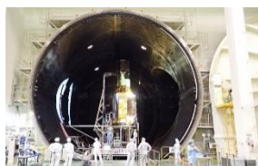
Fig.1 スペースチャンバにおけるXRISM熱真空試験の様子
