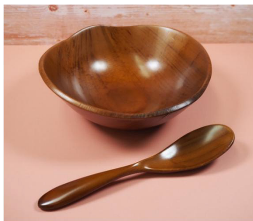
プレス成形試作品(手前:スプーン、奥:サラダボウル)
